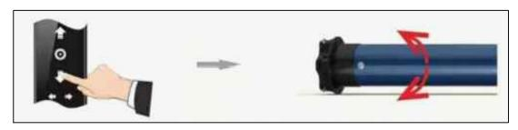
4. Prekidač za pomicanje/kontinuirano pomicanje Prvo uđite u način rada za programiranje (pogledajte stavku 1). Pritisnite tipku STOP na daljinskom upravljaču. Motor se jednom upali, dovršeno je postavljanje funkcionalnosti prel
