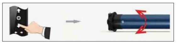
4. Stikalo blokade premikanja/neprekinjenega gibanja Najprej vstopite v programski način (glejte točko 1). Na daljinskem upravljalniku pritisnite gumb STOP. Motor se enkrat premakne, nastavitev stikala se zaključi.
