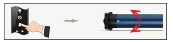
4.Schalter für Bewegungssperre/kontinuierliche Bewegung Gehen Sie zunächst in den Programmiermodus (siehe Punkt 1). Drücken Sie die STOP-Taste auf der Fernbedienung. Der Motor
